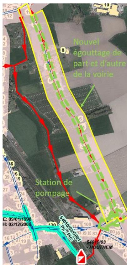
Figure 7 – Proposition d'égouttage avec station de pompage
