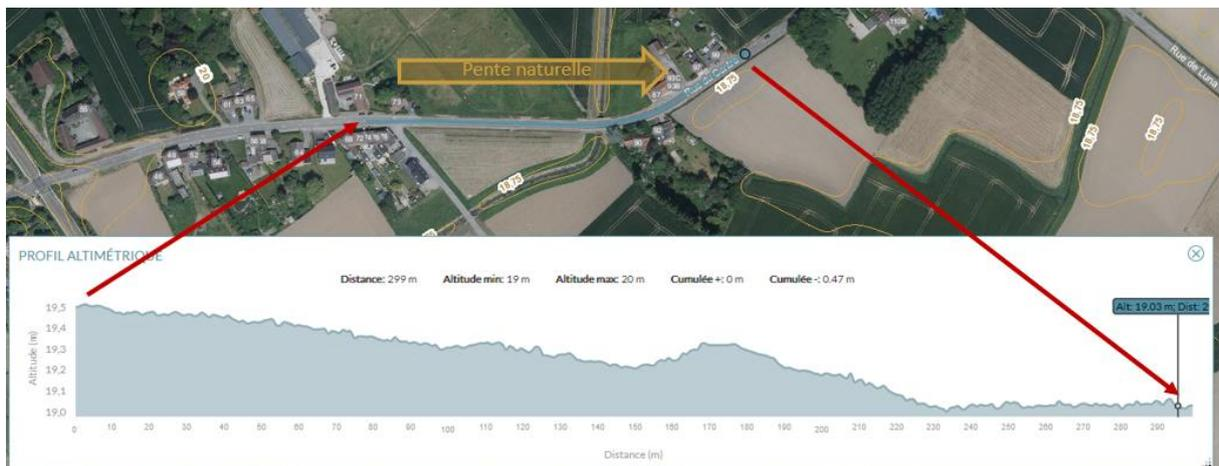
Figure 5 - Profil altimétrique de la rue du Centre, de l'ouest vers l'est.
