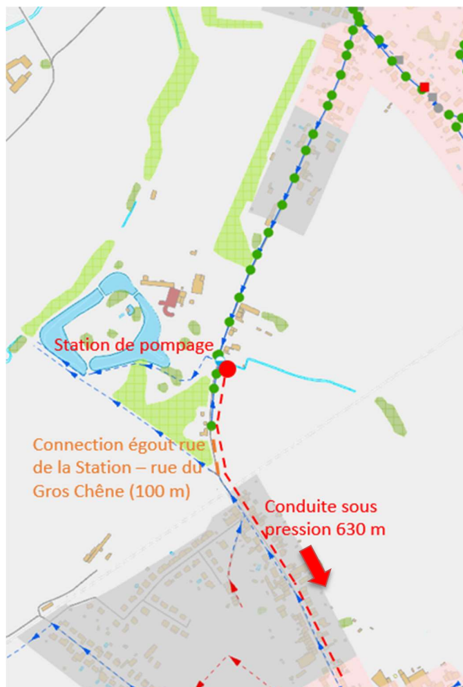
Figure 7 : scénario de collecte et refoulement des eaux vers Mussain
